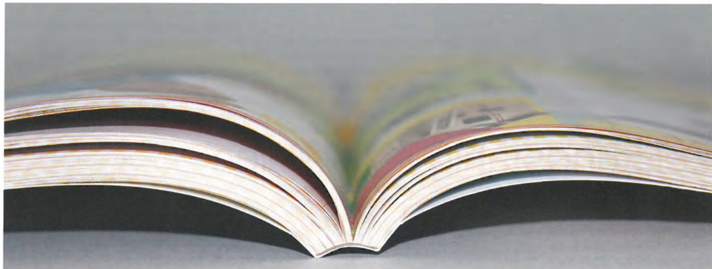
Herausforderung Klebebindung: Auch das Aufschlagverhalten einer Broschur spielt eine große Rolle.
